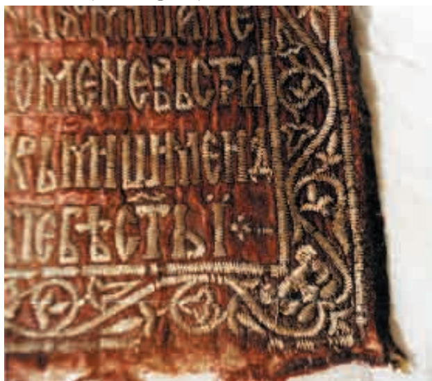
Снимак бр.14: Набори као последица феномена хистерезе на свиленој тканини – власништво аутора
