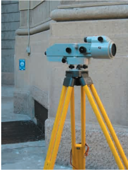
Fig. 4 Automatic level Zeiss Ni1 Сл. 4 Аутоматска либела „Zeiss Ni1”
