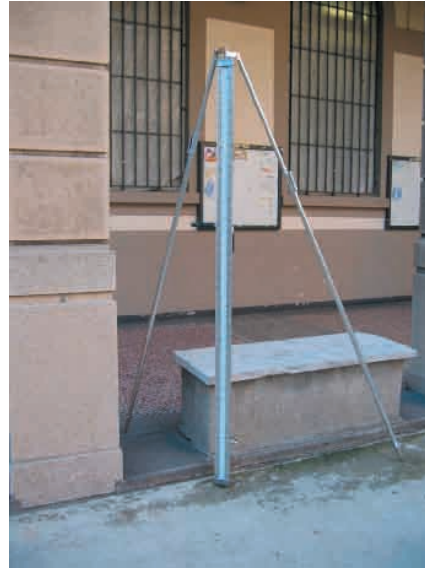
Fig. 5 Rod with invar tape Сл. 5 Летва са траком од инвара
