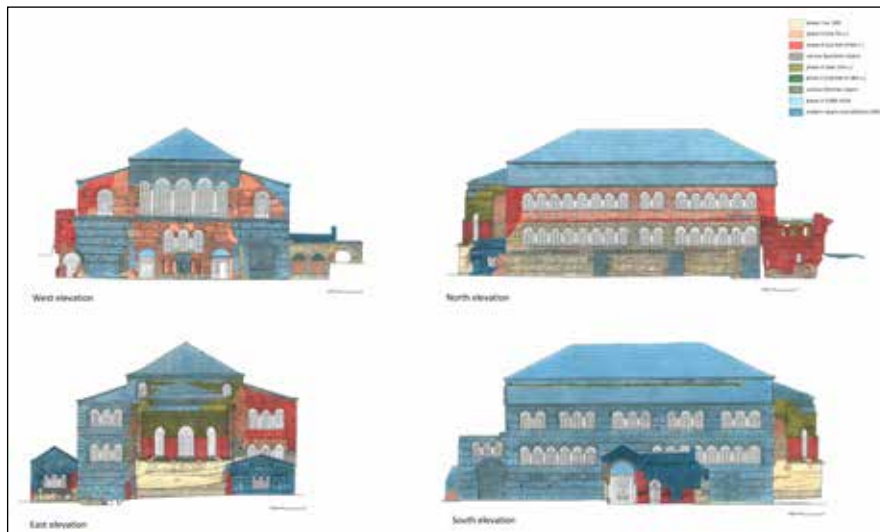
Fig. 5 Acheiropoieitos basilica. Structural Phases: elevations.
